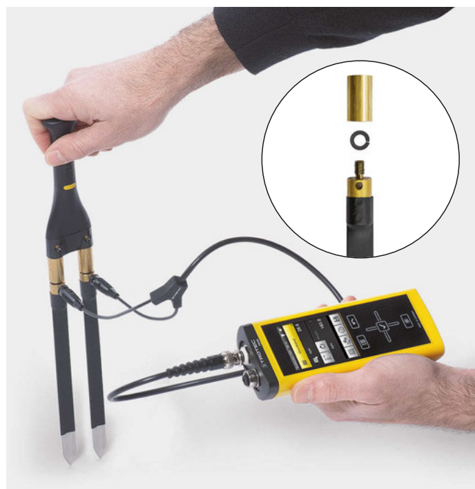
Le kit d'adaptateurs TS 60 (19) permet de fixer toutes les électrodes MultiMeasure directement à l'électrode manuelle TS 60 (9). Les adaptateurs sont équipés d'un filetage de chaque côté et sont simplement vissés entre la tête de l'électrode au moyen de l'anneau de serrage et de la pointe.
