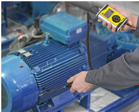
La sonde à bruits de structure à pointe inox est optimale pour les tests de CND, comme les contrôles d'usure de paliers sur les machines tournantes.
