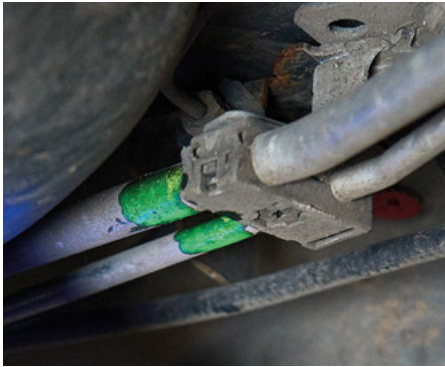
Détection de fuite sur la conduite de fluide réfrigérant d'un climatiseur automobile au moyen d'un agent de contraste.
