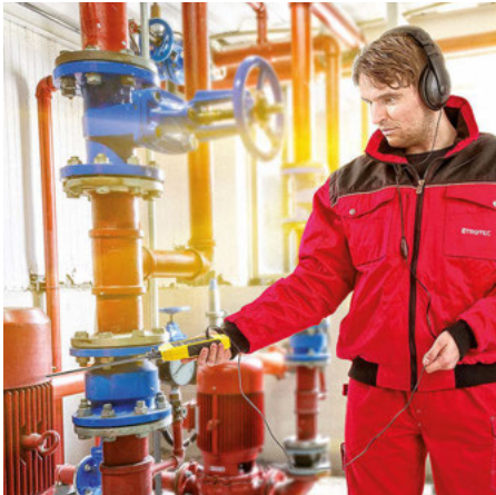
La sonde à bruits de structure permet une détection précoce des apparitions d'usure sur les pompes et autres machines de travail.
