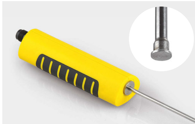
Un contact en argent (ø 6 mm) qui détecte la température de surface se trouve sur la tête de la pointe de mesure (ø 3,5 mm) longue de 150 mm.
