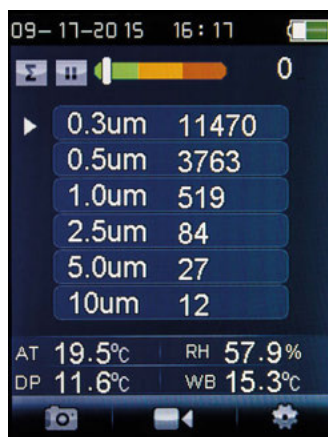
Tous les compteurs de particules déterminent la taille et la concentration de particules présentes dans l'air sur six canaux différents de 0,3 µm à 10 µm avec un affichage d'échelle colorée supplémentaire. Idéal pour le contrôle de contamination, par exemple dans les secteurs cloisonnés avec une atmosphère en surpression ou en sous-pression.
