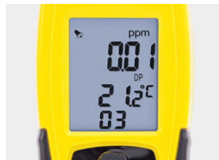
L'écran LCD rétro-éclairé de l'OZ-ONE affiche simultanément, de manière bien lisible même dans des conditions défavorables, les valeurs de deux grandeurs mesurées.
