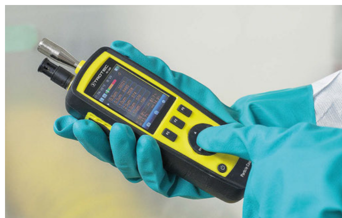
Tous les compteurs de particules déterminent la taille et la concentration de particules présentes dans l'air sur six canaux différents de 0,3 µm à 10 µm avec un affichage d'échelle colorée supplémentaire. Idéal pour le contrôle de contamination, par exemple dans les secteurs cloisonnés avec une atmosphère en surpression ou en sous-pression.
