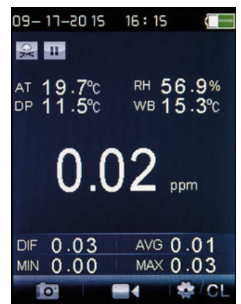
Le PC220 permet également de mesurer les concentrations de monoxyde de carbone dans l'air ambiant.
