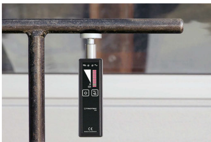
L'aimant en pot permet de mettre en œuvre le LD6 en le fixant simplement et rapidement aux corps métalliques ferreux, par exemple aux clés de bouches d'incendie.
