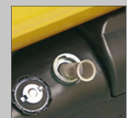
FILTRE POUR EMBOUT DE REMPLISSAGE Pour empêcher la pénétration de saleté N° d'art. 6.100.006.161
