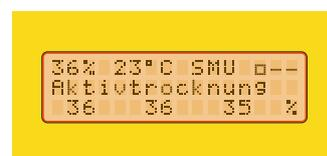
Avec deux capteurs Efidry, l'unité DA 4 Qube enregistre à la fois le rapport de mélange et l'humidité relative de l'air humide, ainsi que l'humidité et la température de l'air ambiant. Toutes les informations d'état sont affichées alternativement en « texte clair » sur l'écran à trois lignes rétroéclairé de l'unité DA 4 Qube.
