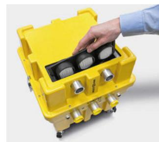
Avec une surface filtrante de 0,16 m<sup>2</sup> et un débit nominal de 50 m<sup>3</sup>/h par élément filtrant, la cassette microfiltre WA 4i est parfaitement adaptée au débit d'air maximal de la turbine à vide du surpresseur MultiQube®.
