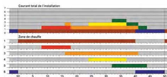
Le module **Power Manager** permet de décaler les périodes de référence de chaque régulateur de puissance. Ainsi, la zone 1 commence à  $T_0$ , la zone 2 à  $T_0+T/6$ , la zone 3 à  $T_0+2T/6$ , etc. **L'effet sur le courant total consommé est immédiatement visible.**
