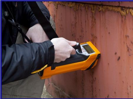
Le grand volume du détecteur à scintillation NaI(Tl) fournit une **haute sensibilité** et une excellente résolution pour une identification des radio-isotopes rapide et fiable.
