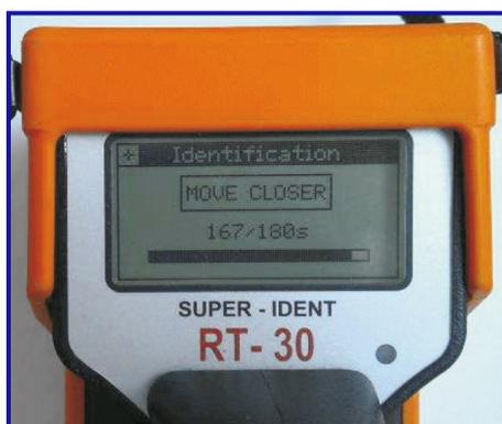
L'activation du mode **identification** lance l'acquisition complète du spectre Gamma. Le RT-30 mesure le niveau de radiation et demande à l'utilisateur de se rapprocher, s'aligner ou bien rester en place.
