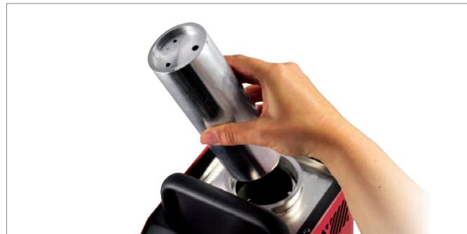
Le transfert thermique optimal entre le bloc et l'échantillon à tester est obtenu par l'utilisation de l'insert adéquat. Idéalement, le diamètre de perçage doit être plus large de 0,5 mm par rapport au diamètre extérieur de la sonde de l'échantillon à tester. La viscosité, le point flash ou température d'évaporation ne sont pas concernés.
