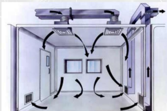
Salle blanche à flux laminaire permettant de maintenir les impuretés au sol avant d'être filtrées
