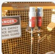
**Pression en service de 6 bars permet un montage déporté jusqu'à 5 m max.**
