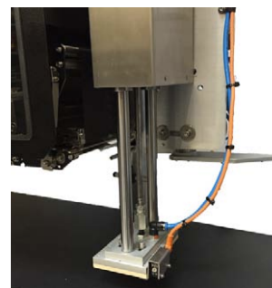
Module de récupération des tags RFID défectueux
